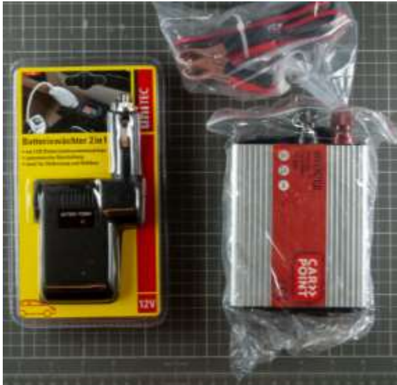
Batteriewächter, Unitec, verpackt Spannungswandler Car Point
